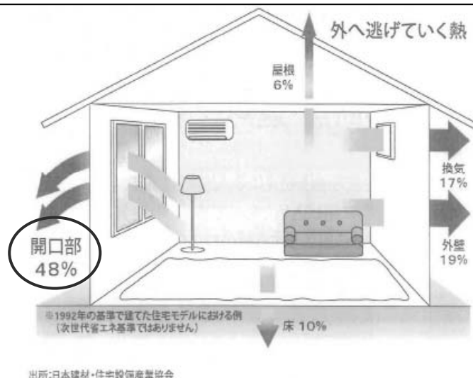
図2 冬の暖房時に開口部から熱が逃げる割合 48%
